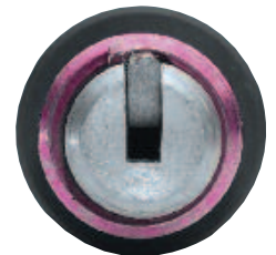
Entraîneur parfaitement pris dans l'encoche
