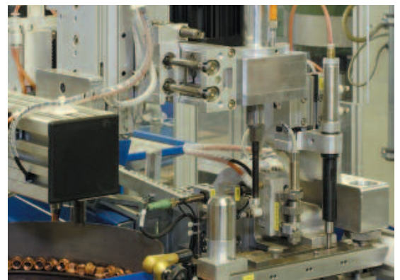
Pose automatique HELICOIL® plus M 8 SCREWLOCK®.
