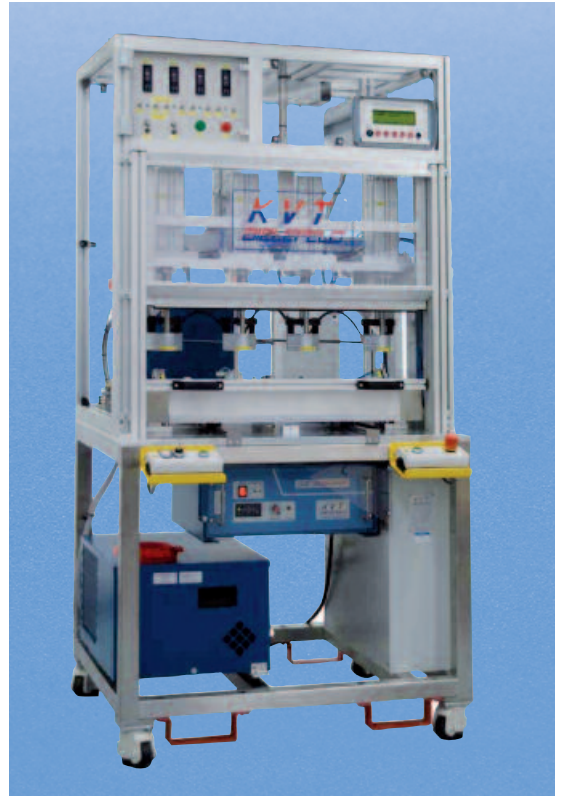
Machine de pose thermique par soudage par résistance électromagnétique ERW, pour l'assemblage de quatre inserts dans une poignée de démarrage
