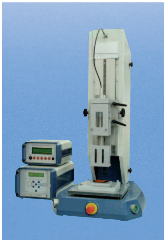
Machine de pose par ultrasons avec une fréquence de fonctionnement de 20kHz permettant de riveter, de souder ou d'assembler des inserts UNITEC K' in K' ("plastic in plastic"). Elle permet de contrôler tous les paramètres et de les transmettre vers un système d'acquisition de données de production
