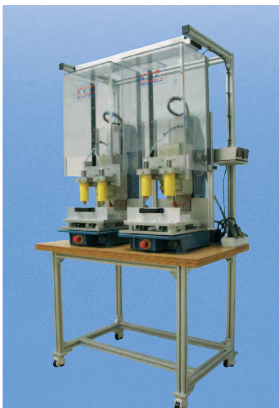
Machine de pose thermique KVT basic 5000 DUO, conçue pour assembler simultanément quatre inserts dans deux boîtiers de rétroviseurs
